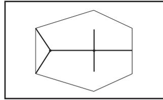
**2** Tous les segments des arceaux sont reliés entre eux au moyen d'un cordon élastique. Insère délicatement les différents segments les uns dans les autres et pose les arceaux sur la tente intérieure.
